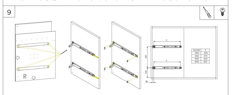
Сделайте разметку фасада согласно шаблона или размеров присадок. Зафиксируйте фасадные кронштейны Н согласно разметке.
