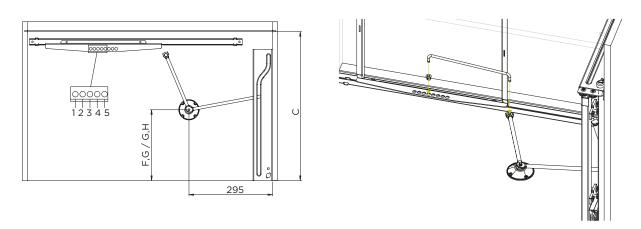
Соедините поворотный рычаг I с задней рамой при помощи планки M и пластиковой втулки L (см. схему). При необходимости отрегулируйте вылет задних корзин, перемещая планку M в наиболее подходящее отверстие на раме.
