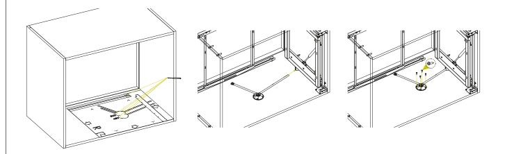
Зафиксируйте поворотный рычаг I (согласно разметке, пункт 1), совместив его с проушиной в боковой раме.
